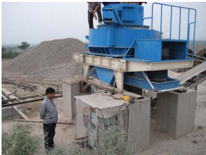
新型制砂机VSI-9526在山西安装调试
