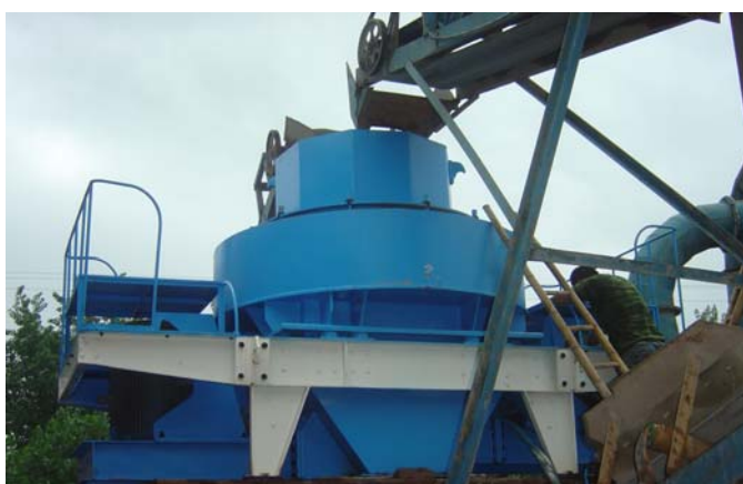
新型制砂机VSI-8518在安徽六安安装调试
